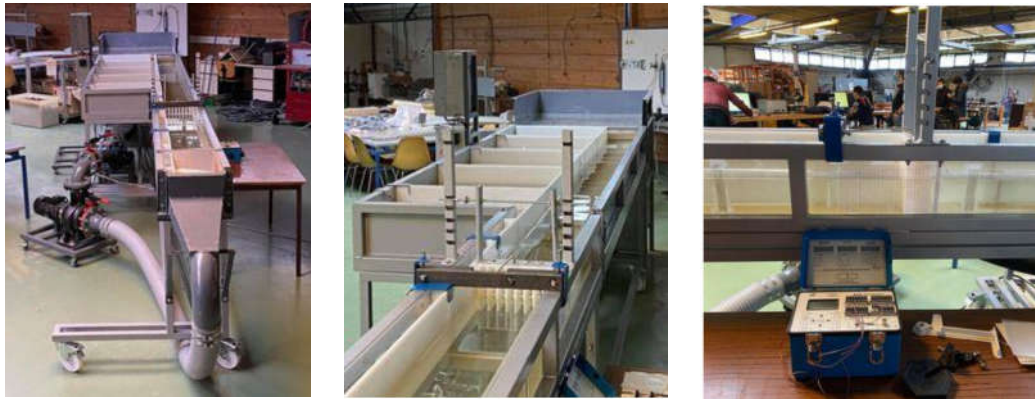
Figure 1 : Dispositif expérimental du SIAME et principe de la mesure de force sur un plan de grille.
